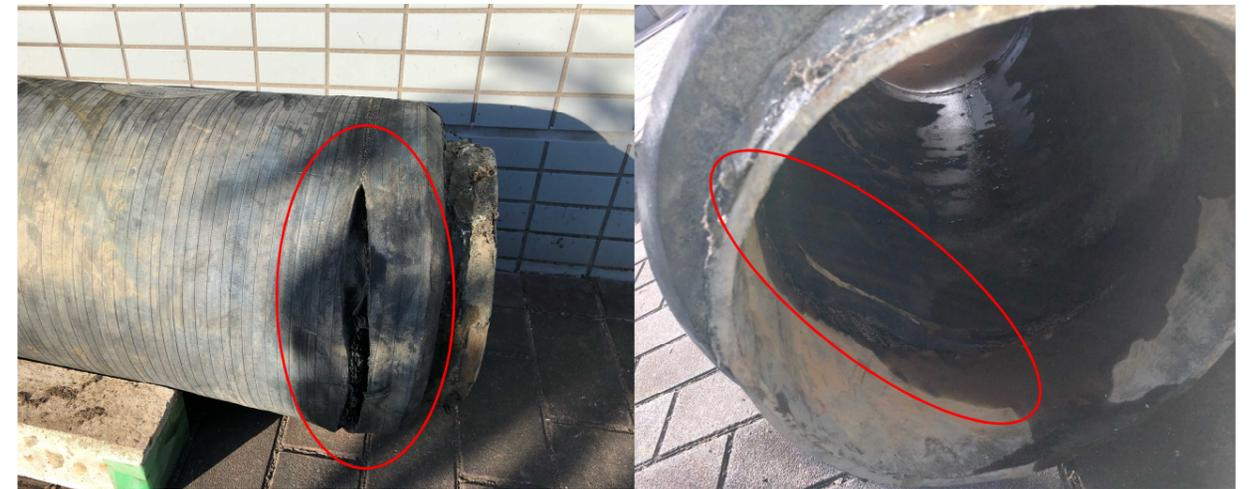
図11 (写真) ゴム製可とう継手<sup>\*</sup>詳細
