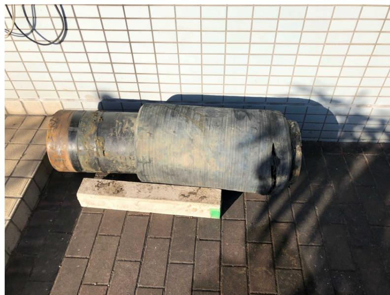
図10 (写真) ゴム製可とう継手<sup>\*</sup>
